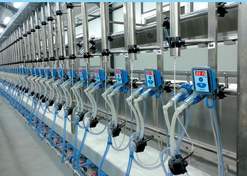
TDM è in grado di realizzare impianti per ovi-caprini di diverse tipologie equipaggiati con le più moderne tecnologie e dotati di stacchi automatici a flusso.
