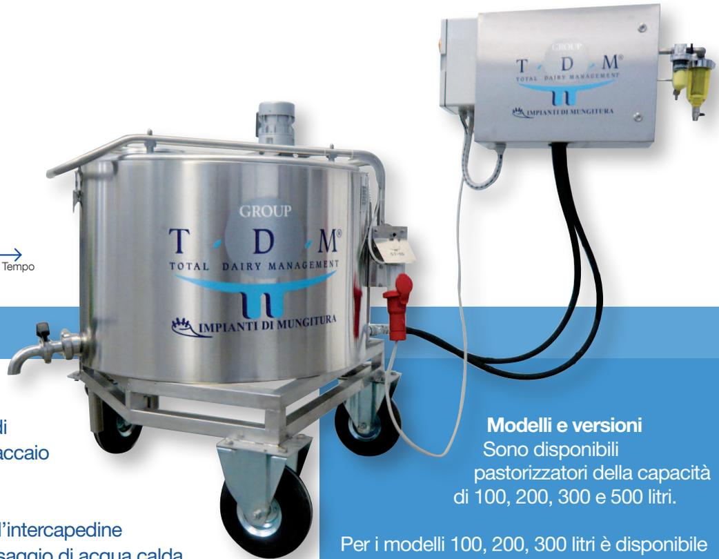
Vasca totalmente in acciaio inox coibentata, supportata da un telaio di sostegno anch'esso interamente in acciaio inox su piedi o ruote.
